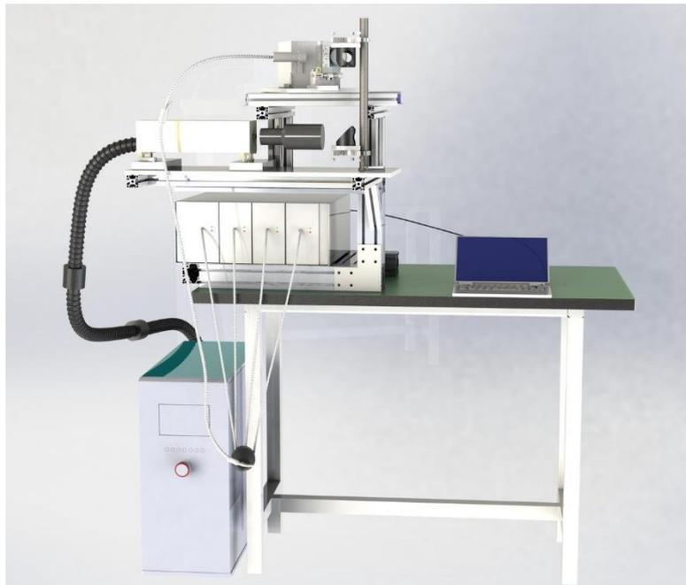
激光诱导击穿光谱（Laser Induced Breakdown Spectroscopy, LIBS）技术是通过超短脉冲激光聚焦后烧蚀材料表面产生等离子体，材料被激发形成等离子体后会发出特征谱线，利用光谱仪分析该等离子体的发射光谱，可以识别样品中的元素组成成分，可以进行材料的识别、分类、定性以及定量分析。
